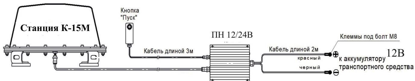
Схема установки станции К-15М на легковой автомобиль с напряжением бортовой сети 12 В
